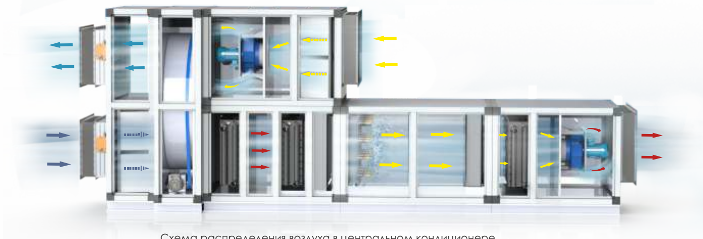
Схема распределения воздуха в центральном кондиционере
