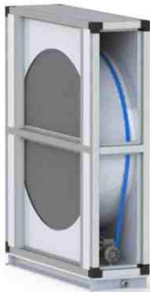
Для работ в агрессивной среде. Принцип работы роторного рекуператора следующий: вытяжной воздух проходит через одну половину ротора теплообменника, нагревая при этом его поверхность. Затем с помощью ременного привода ротор совершает медленное вращение и через него постепенно начинает проходить поток холодного наружного воздуха в противоположном вытяжному воздуху направлении.
