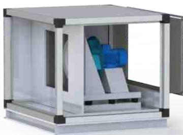
предназначена для забора необработанного воздуха с улицы и подачи обработанного в обслуживаемое помещение. Состоит из корпуса, радиального рабочего колеса, конфузора, электродвигателя, крепежной рамы и виброизолирующих опор. Свободно вращающееся рабочее колесо установлено на валу электродвигателя. Рабочее колесо с 7 изогнутыми назад лопатками изготовлено из листовой стали с защитным покрытием, нанесенным методом порошкового напыления.
