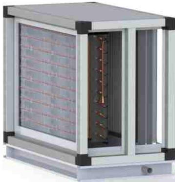
изготовлены из медных трубок и алюминиевого оребрения. Они предназначены для охлаждения потока воздуха до требуемой температуры, используя процесс переноса тепла от воздуха к кипящему хладагенту. В качестве хладагентов чаще всего используются фреоны R410a и R407c.
