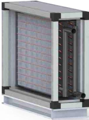
изготовлены из медных трубок и алюминиевого оребрения. Они предназначены для нагрева потока воздуха до требуемой температуры, используя теплоту циркулирующего по системе трубок теплоносителя. В установках внутреннего исполнения в качестве теплоносителя как правило используется горячая вода, а в установках наружного исполнения необходимо применять незамерзающие растворы.
