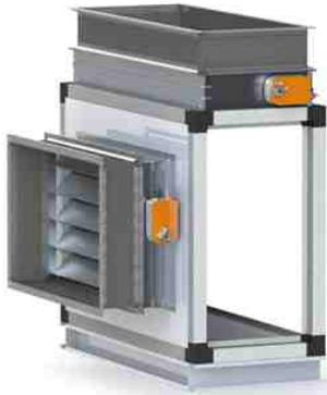
секция центрального кондиционера, в которую поступает необработанный воздух (с начальными параметрами). Секция состоит из корпуса и воздушных клапанов с электроприводами. Воздушный клапан состоит из прямоугольного корпуса, набора лопаток, штоков и шестерен. Для изготовления воздушных клапанов, как правило, применяются специальные алюминиевые профили. Для предотвращения примерзания лопатки оснащены резиновым уплотнителем. Опционально может устанавливаться электрический подогрев.
