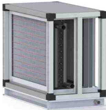
изготовлены из медных трубок и алюминиевого оребрения. Они предназначены для охлаждения потока воздуха до требуемой температуры, используя процесс переноса тепла от воздуха к хладоносителю. В установках внутреннего исполнения в качестве хладоносителя как правило используется захлажденная вода, а в установках наружного исполнения – незамерзающие водные растворы. Для постоянного обеспечения секции хладоносителем применяются водоохлаждающие агрегаты – чиллеры.
