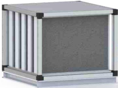
предназначена для снижения и предотвращения распространения аэродинамического шума, создаваемого вентиляторами и другими секциями центрального кондиционера. В секции на определенном расстоянии друг от друга расположены кассеты, заполненные шумопоглощающим материалом. Внешняя поверхность кассеты покрыта стекловолокном для предотвращения уноса волокон шумопоглощающего материала потоком воздуха.
